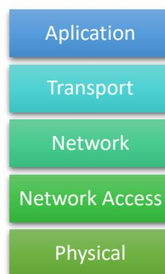
**Gambar 1.12** Lima lapisan rangkaian protokol TCP/IP
