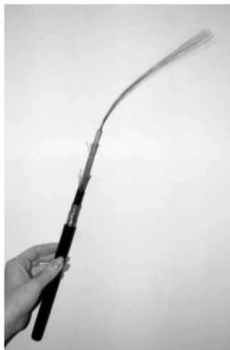
**Gambar 3.7 Kabel serat optik dengan banyak helai serat**
