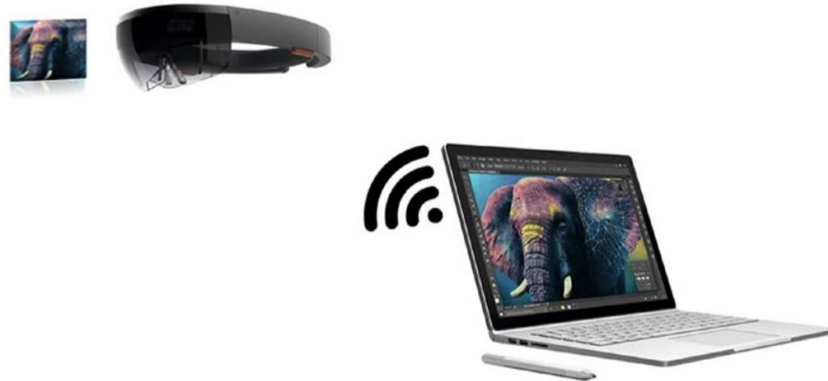
Gambar 1-1. Ilustrasi jarak jauh holografik. PC mengalirkan aplikasi ke HoloLens untuk dilihat, tanpa perlu menginstal aplikasi uji pada HoloLens.
