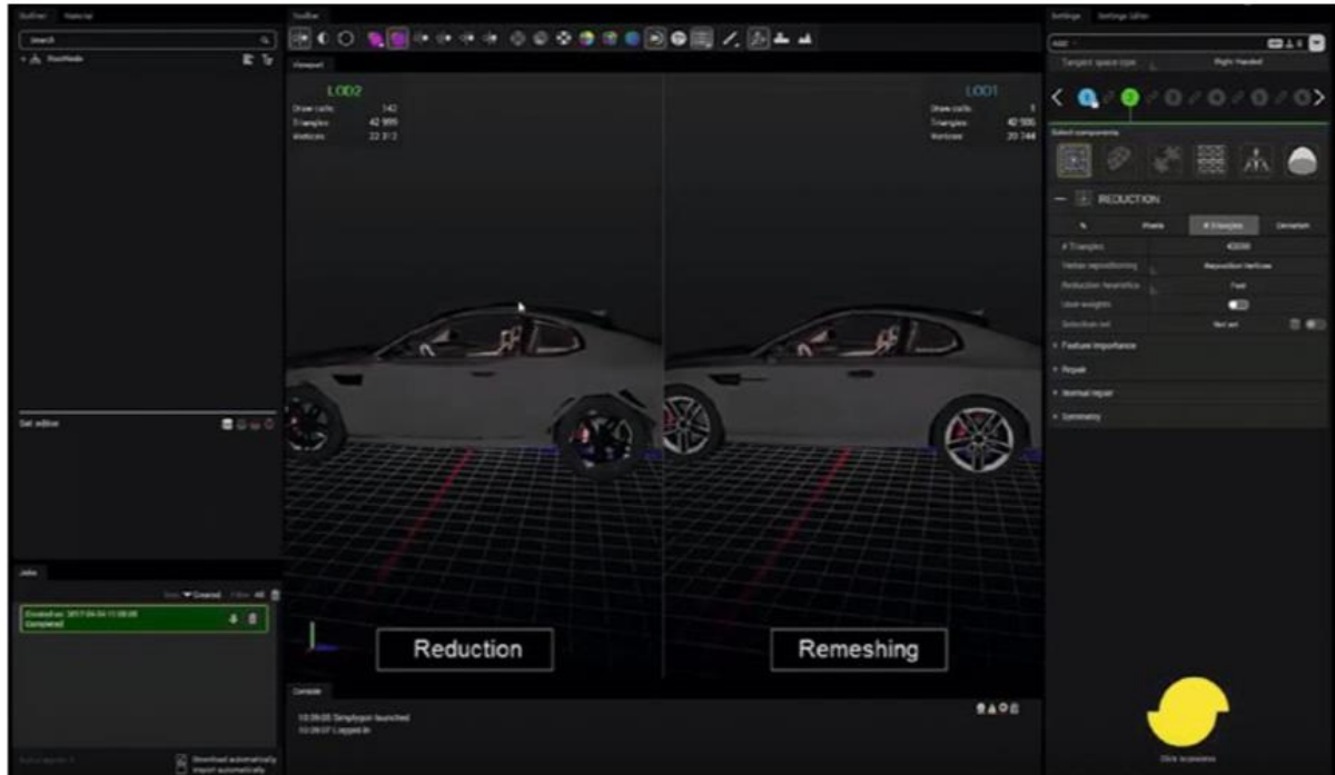
Gambar 8-9. Simplygon memungkinkan Anda mengonversi model 3D yang besar dan kompleks menjadi model poli rendah yang indah yang berkinerja baik di HoloLens
