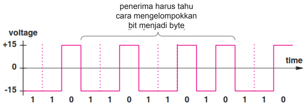
Gambar 9.6 Ilustrasi transmisi sinkron dimana bit pertama dari suatu byte segera mengikuti bit terakhir dari byte sebelumnya.
