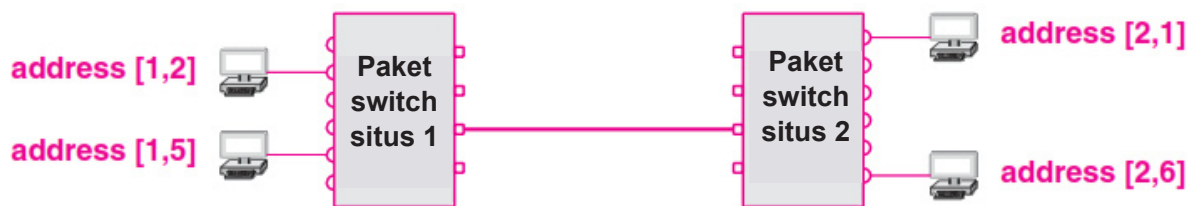
Gambar 18.4 Contoh hierarki alamat di mana setiap alamat mengidentifikasi switch paket dan komputer yang terhubung ke switch.
