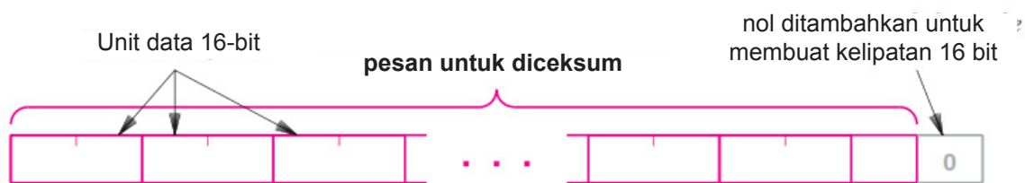
Gambar 8.6 Internet checksum membagi data ke dalam unit 16-bit, menambahkan nol jika data tersebut bukan kelipatan tepat dari 16 bit.
