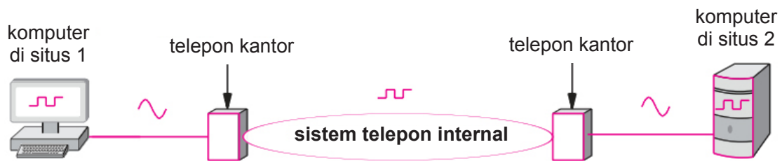
Gambar 10.10 Ilustrasi sinyal digital dan analog (dilambangkan dengan gelombang persegi dan gelombang sinus) yang terjadi ketika modem dialup digunakan untuk mengirim data dari satu komputer ke komputer lain.
