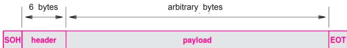
Gambar 13.7 Contoh format frame yang menggunakan karakter SOH dan EOT untuk menggambarkan sebuah frame.
